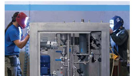
Soldadura orbital para las tuberías
