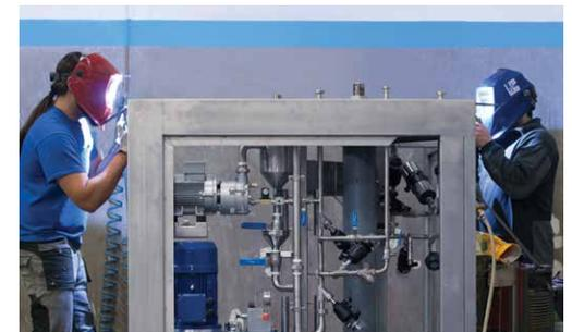
Soldadura orbital para las tuberías
