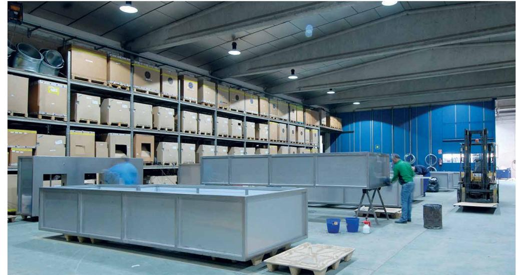
**Foto arriba:** Fase de ensamble de módulos de flujo laminar en nuestra planta de fabricación.
