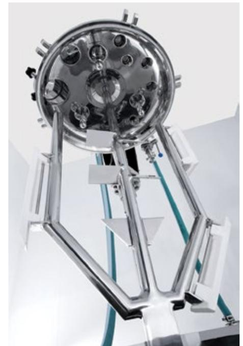
Sistema de doble agitación con homogeneizador de fondo y ancla con rascadores.
