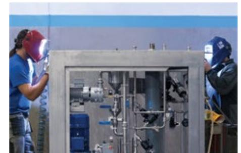
Soldadura orbital para las tuberías
