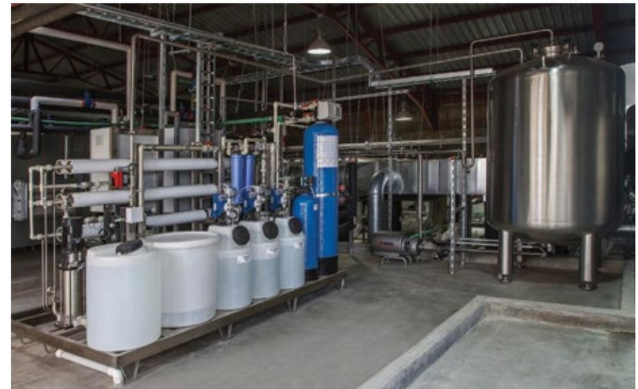
Pretratamiento de agua y generación de agua purificada (PW), incluyendo *loop* de distribución y tanque de almacenamiento.
